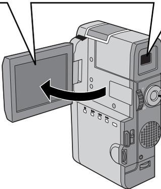
Para conectar la alimentación de la cámara de video primero gire el disco de alimentación hacia cualquier modo de operación, exceptuando "OFF", luego tire del visor para extenderlo o abra el monitor LCD. Cuando se gira el disco de alimentación de "OFF" a cualquier otra posición, mantenga presionado el botón de bloqueo ubicado en el disco.
